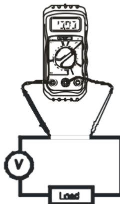
4. Для измерений тока более 10A DC, установите переключатель режимов в позицию A и вставьте штекер красного вывода в гнездо 10A.
