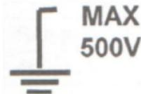
Данный символ указывает, что терминал(ы), маркированные таким образом, нельзя подключать к точке цепи, на которой напряжение в отношении грунтового заземления превышено (в данном примере) 500 В AC или DC.
